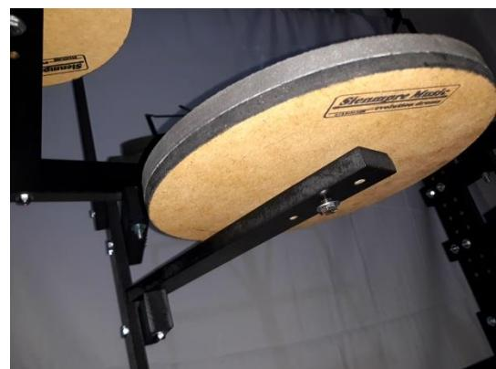
Passo 6: Com uma chave Phillips, reforce todos as conexões com o parafuso a seguir. Use os furos como guia e faça uma força para o parafuso entrar nas outras peças que não possuem furo.
